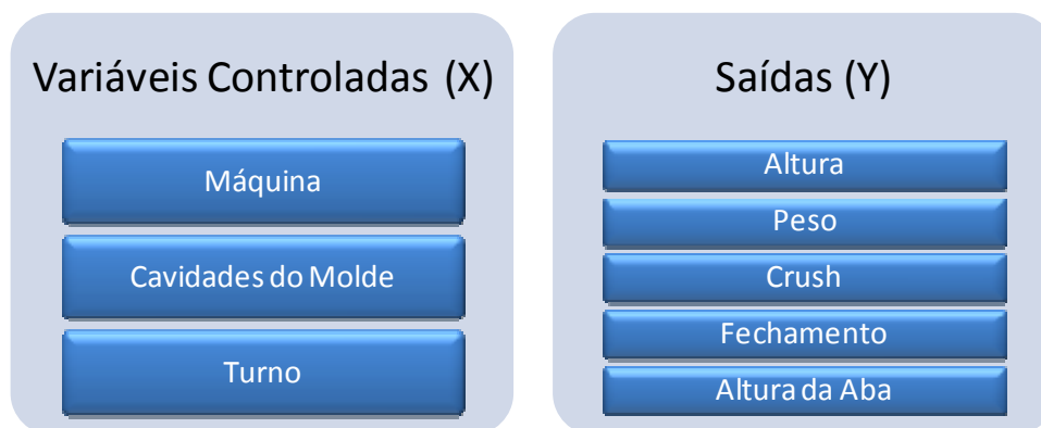
Figura 4.6: Variáveis controladas (x) e saídas (y) do processo: Y=f(x) . Elaborado pelo autor.
